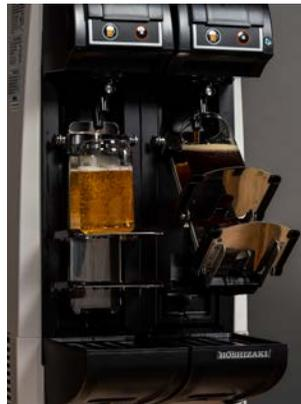
Die beiden Glashalterungen lassen sich unabhängig voneinander einstellen, sodass zwei verschiedene Gläsergrößen zum Einsatz kommen können. Die Führung kann auch an die Form der verwendeten Gläser angepasst werden. Die Mindest-Höhendifferenz von/zwischen den beiden Flächen: 20 mm
